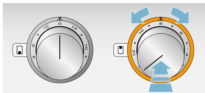
Поворачивая регулятор, можно установить ступень нагрева конфорки.
