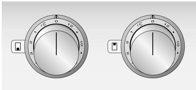
Маркировка ручек управления указывает на принадлежность к соответствующей конфорке и регулировку в диапазоне между варочными ступенями 1 и 12 или ступенью подогрева (▲).
