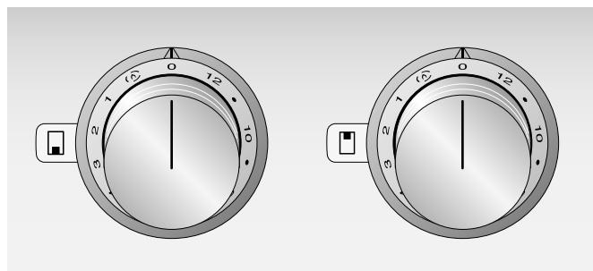
Kumanda düğmelerindeki işaretler düşmenin ait olduğu brülörü belirler ve 1 ile 12 arası pişirme kademesi ile fasılalı yanma kademesi (⌚) ayarını gösterir.
