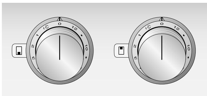
Oznaczenia na pokrętle pokazują przyporządkowanie do danego palnika oraz ustawienie poziomu gotowania od 1 do 12 bądź wrzenia ( $\Delta$ ).
